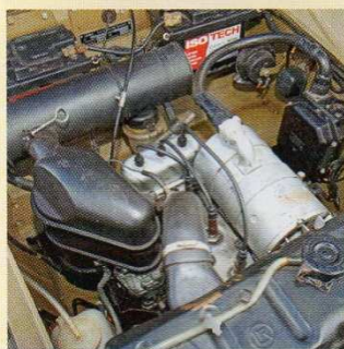
On aperçoit tout juste le petit 3-cylindres deux temps sous l'énorme dynamo 24 volts.
