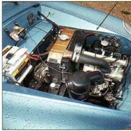
**Le petit 3-cylindres 2-temps de la DKW développe tout de même 60 ch. Notez le radiateur placé à l'arrière...**
