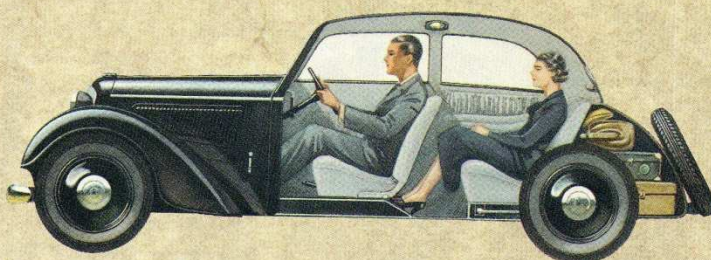
Avantage pratique de la Traction avant : un plancher plat permettant d'exploiter au maximum le volume habitable.
